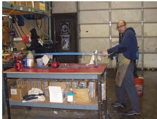
スキ어의心材にグラスファイバーを塗り広げる。
